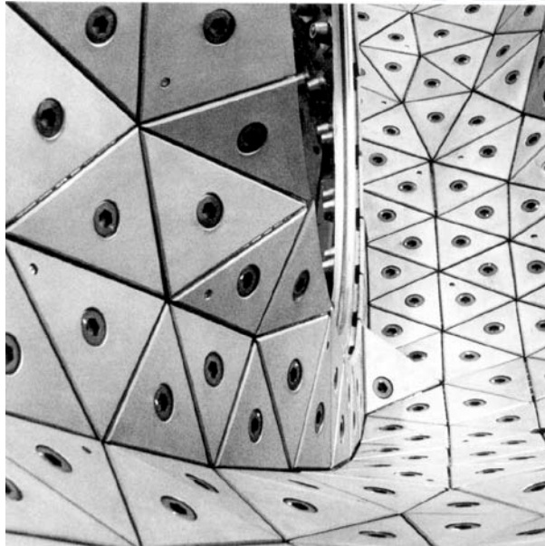
Keramikauskleidung der Brennkammer
